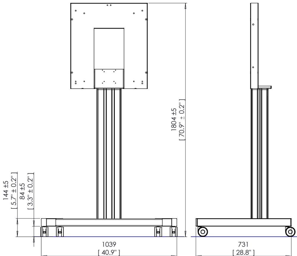
Suporte móvel não ajustável em altura para ActivPanel 2019 v7 5S 05/20 v1.1 PT-PT
